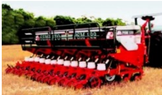
Figura 2. Semeadora de Precisão Fonte: Semeato Semeadoras
